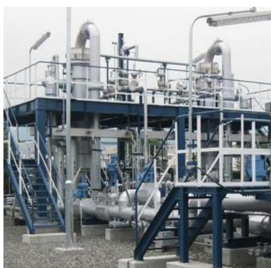
超低温合成反応装置
